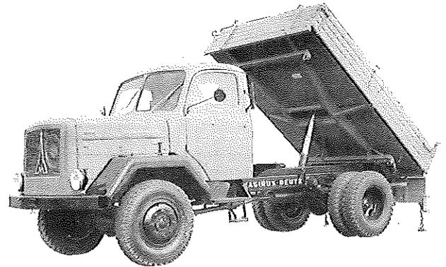
Diesel-Motor · 6-Zylinder · 4-Takt 112 PS bei 2300 U/min
